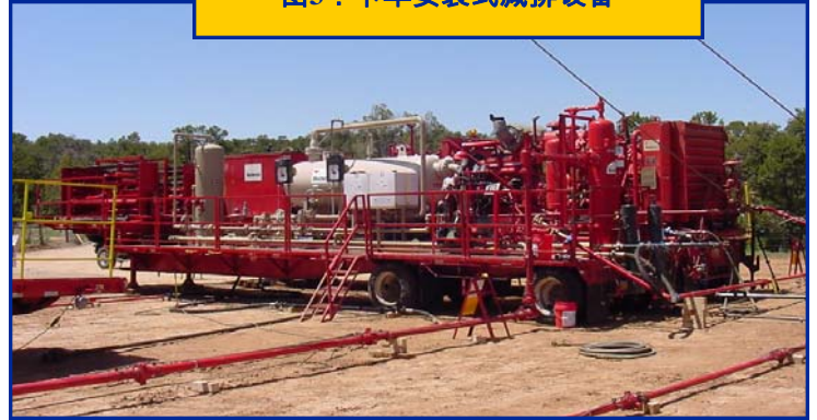
图3：卡车安装式减排设备
