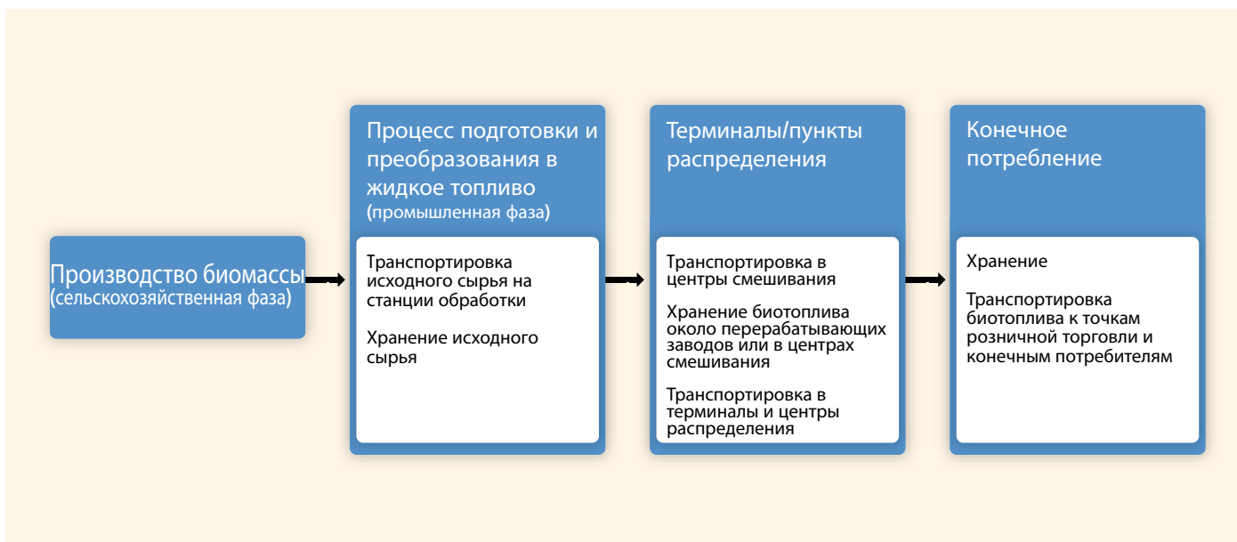
Рисунок TP.8.5 | Системы производства, смешивания и распределения для ряда жидких видов биотоплива одинаковы для всех видов исходного сырья для биомасс. [рисунок 8.11]
