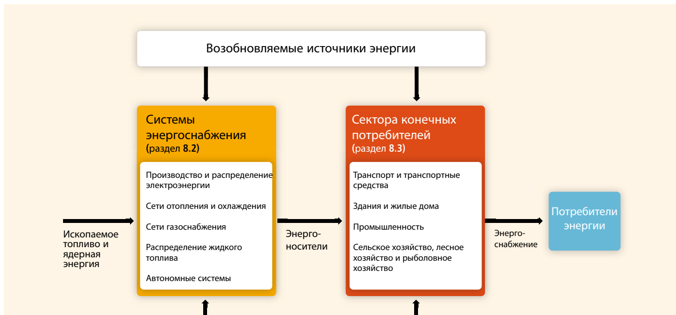
Рисунок РП.7 | Пути интеграции ВИЭ для обеспечения энергоуслуг либо в системы энергоснабжения, или на местах для использования секторами конечных потребителей. [рисунок 8.1, 8.1]
