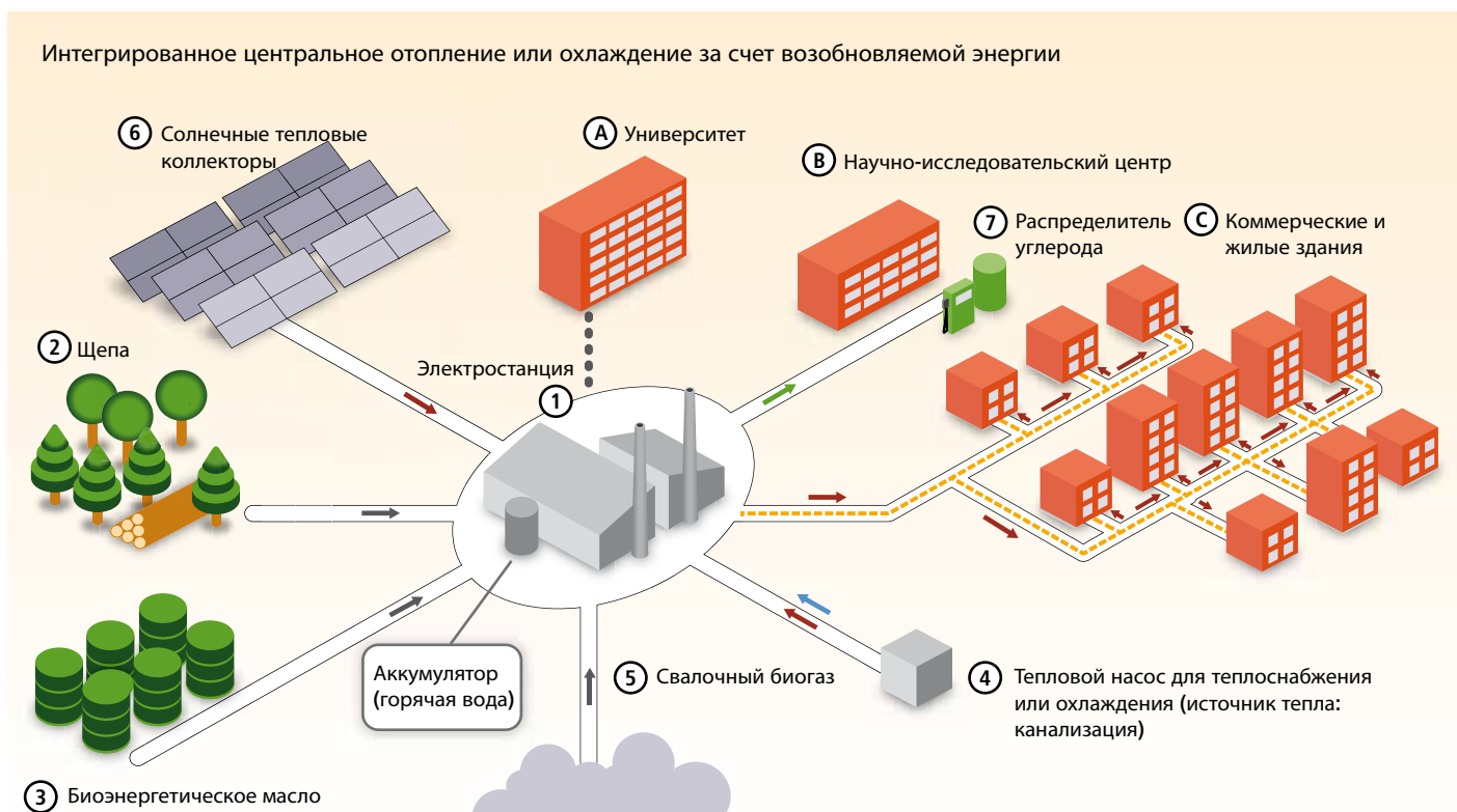
Рисунок TP.8.3 | Электростанция, работающая на ВИЭ в Лиллестеме, Норвегия, снабжающая университет, научно-исследовательский центр и ряд коммерческих и жилых зданий с использованием системы центрального теплоснабжения и охлаждения, работающей на возобновляемой энергии, и включающей ряд источников тепла, термального хранения и производства водорода, а также системы распределения. (Общая сумма инвестиций, которые подлежат завершению в 2011 г., составила около 25 млн долл. США 2005 ) 1) Центральная энергетическая система с аккумулятором емкостью 1 200 м 3 , который представляет собой накопительный бак с горячей водой; (2) система сжигания древесины 20 МВт t (с улавливанием горячих отходящих газов); (3) сжигатель биомасла 40 МВт t ; (4) 4,5 МВт тепловой насос; (5) сжигатель свалочного газа 1,5 МВт t и 5 км трубопровод; (6) система солнечных тепловых коллекторов 10 000 м 2 ; и (7) производство водорода на основе ВИЭ (с использованием водного электролиза и усиленной сорбции потоков метана за счет реформирования свалочного газа) и система распределительных транспортных средств. [рисунок 8.3]
