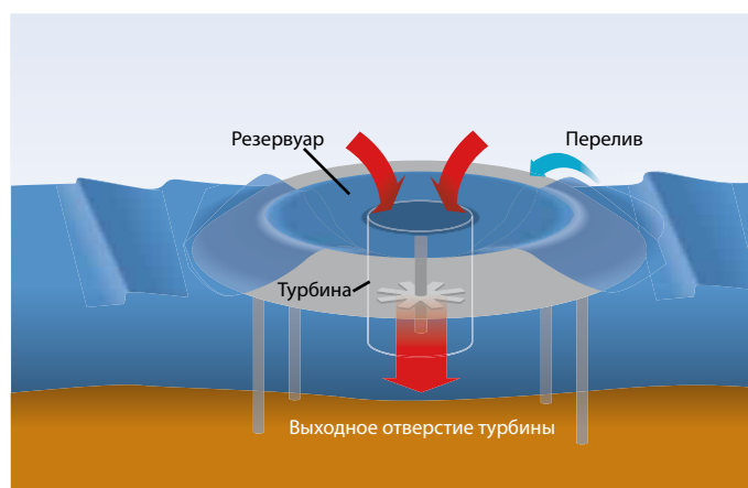
Рисунок TP.6.2a/b | Тип преобразователя энергии волн и принцип его работы: установка с осциллирующим водяным столбом. [рисунок 6.6] (оформление Национальной лаборатории возобновляемой энергии (НАВЭ)).
