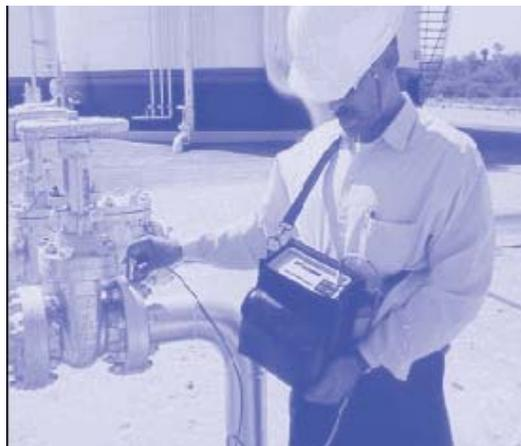
图 A-3 声学泄漏检测
